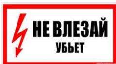
Для предупреждения об опасности подъема по конструкциям, при котором возможно приближение к токоведущим частям, находящимся под напряжением
